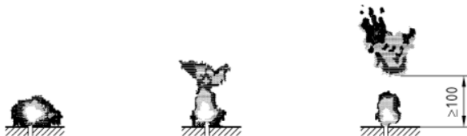
Рисунок 2 – Схематичне зображення критерія відриву полум'я
