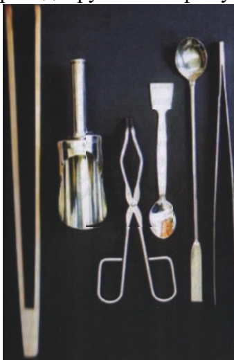
Рисунок 1 - Відповідні матеріали для відбору проб твердих речовин (зліва направо): щипці дерев'яні, лопатка, тигельні щипці, ложка-лопатка мала, ложка шпатель велика, щипці.
