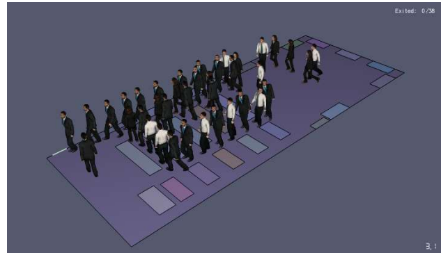
Рисунок 4 – Розміщення людей в навчальній аудиторії для моделювання в Pathfinder та початок евакуації.
