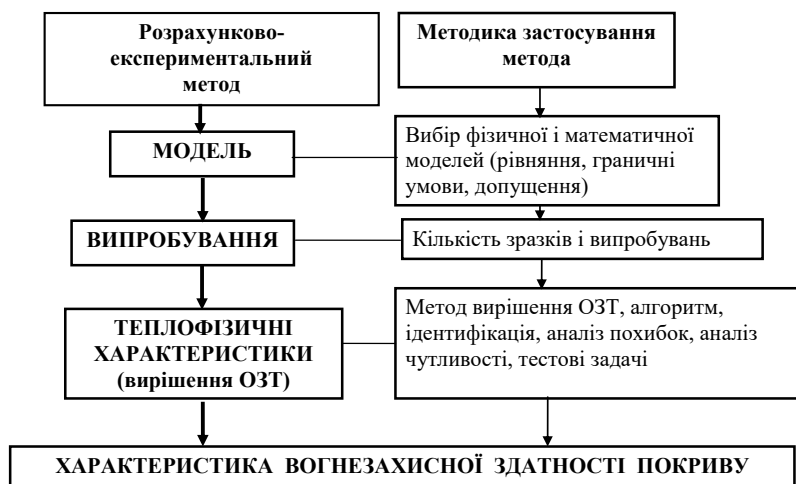
Рисунок 1 – Схема застосування розрахунково-експериментального методу визначення вогнезахисної здатності покриттів
