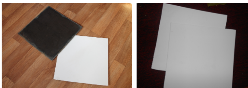
Рисунок 2 – Загальний вигляд сталевих пластин після нанесення вогнезахисної речовини.
