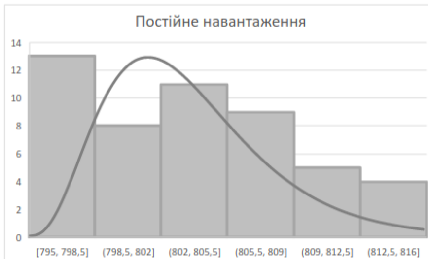
Рисунок 3. Визначення розрахункових значень постійного навантаження за результатами натурних обстежень
