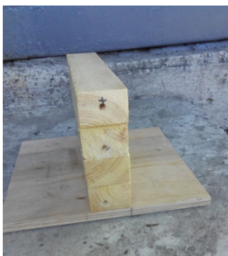
Рисунок 2. Загальний вигляд експериментального зразка-фрагмента дерев'яної балки: з облицюванням вогнезахисною фанерою: а) без вогнезахисту; б) з одним шаром вогнезахисного облицювання; в) з подвійним шаром вогнезахисного облицювання
