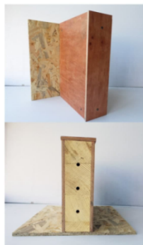
Рисунок 2. Загальний вигляд експериментального зразка-фрагмента дерев'яної балки: з облицюванням вогнезахисною фанерою: а) без вогнезахисту; б) з одним шаром вогнезахисного облицювання; в) з подвійним шаром вогнезахисного облицювання
