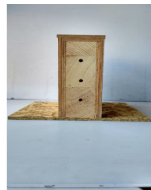
Рисунок 2. Загальний вигляд експериментального зразка-фрагмента дерев'яної балки: з облицюванням вогнезахисною фанерою: а) без вогнезахисту; б) з одним шаром вогнезахисного облицювання; в) з подвійним шаром вогнезахисного облицювання
