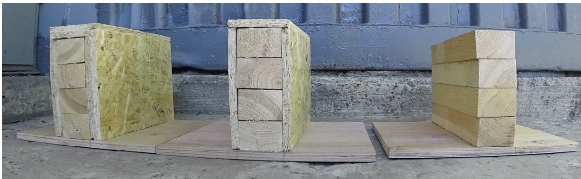
Рисунок 1. Загальний вигляд експериментального зразка-фрагмента дерев'яної балки з облицюванням OSB плит: а) з подвійним шаром вогнезахисного облицювання; б) з одним шаром вогнезахисного облицювання; в) без вогнезахисту
