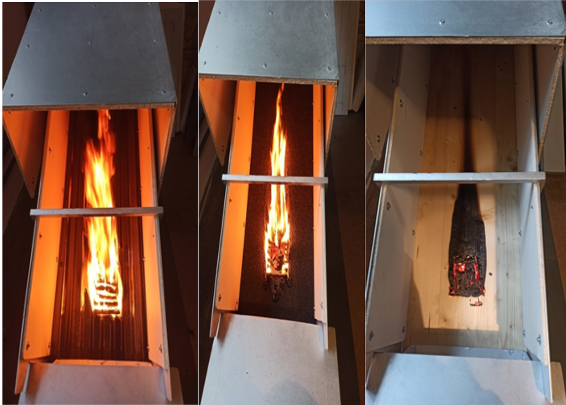
Рисунок 3. Зображені робочі моменти випробувань покрівель на стійкість до зовнішнього вогневого впливу
