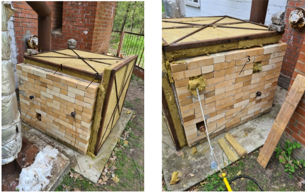
Рисунок 2 – Розташування термопар у стінах випробувальної установки для дослідження температурного розподілу у камері печі: 1-3 – термопари типу ТХА.
