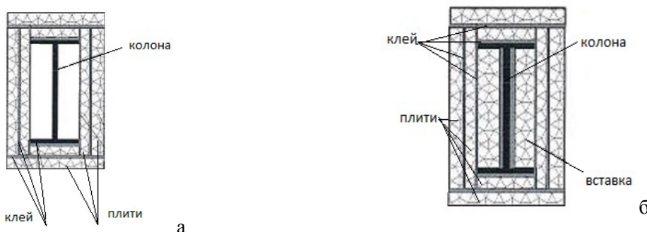
Рисунок 2 – Схема перерізу зразків у відповідності до схеми вогнезахисту. а – переріз зразків № 1, 2, 5, 6; б – переріз зразків № 3, 4, 7, 8
