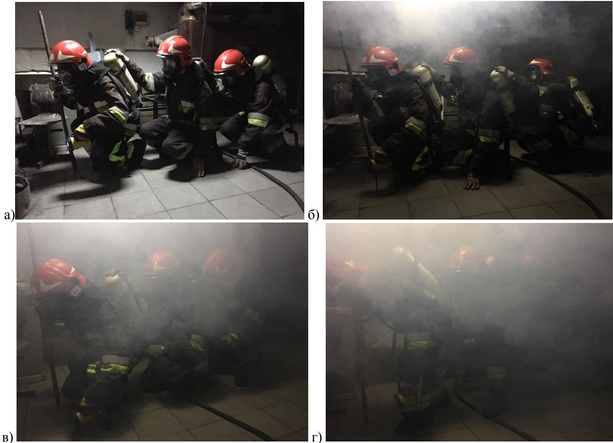
Рисунок 2 – Експериментальні дослідження з визначення швидкості руху пересування ланки ГДЗС в залежності від видимості: а) від 6 до 12 м; б) від 3 до 6 м; в) до 3 м; г) відсутня видимість – менше 1 м
