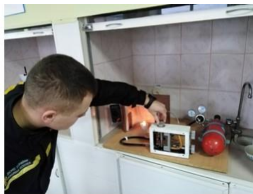
Рисунок 4 – Проведення експериментальних досліджень з визначення впливу газообміну на швидкість гасіння пожежі діоксидом вуглецю
