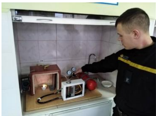
Рисунок 4 – Проведення експериментальних досліджень з визначення впливу газообміну на швидкість гасіння пожежі діоксидом вуглецю
