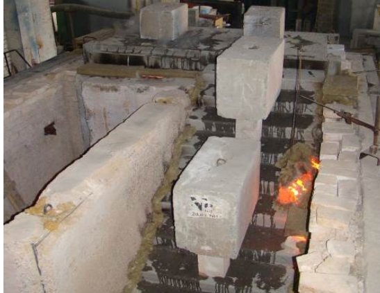
Рисунок 2. Експериментальна установка із зразком під час вогневого випробування.
